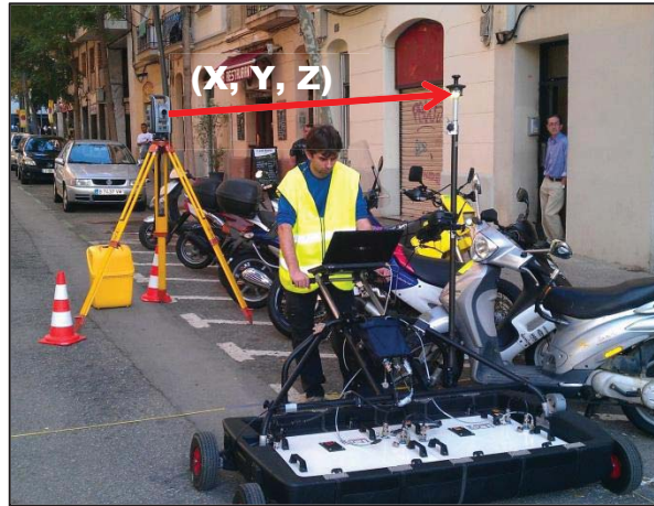
Fig. 4. Posicionament de les dades de georadar. En segon pla es veu l'estació total robòtica emprada, Trimble S8. En primer pla una imatge de la matriu d'antenes de georadar.
