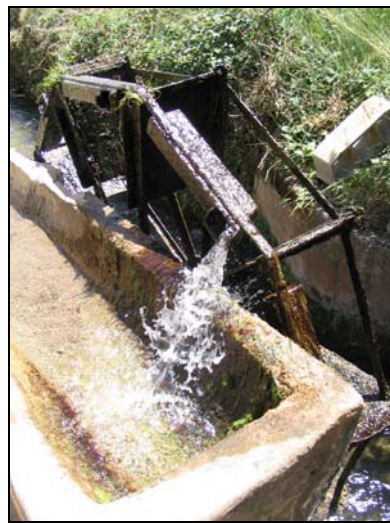
Sinia en funcionament, amb catúfols metàl·lics 8
